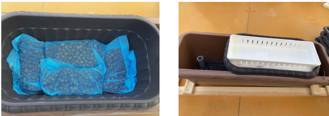
図2 循環ろ過器（左：ハイドロボール、右：組み立て完了）
