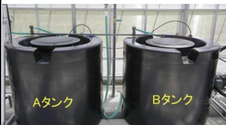
トマトに給液する培養液の濃度の100～400倍の濃縮液を作成する。高濃度で沈殿する肥料成分があるため、AタンクとBタンクの2つの原液タンクに分ける。
